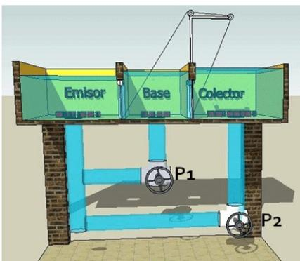
En la Base de los compartimentos Colector y Base, se encuentra una compuerta a la cual llamaremos D2. Puede subir y bajar, gracias a un dispositivo mecánico mandado por la otra compuerta (D1).
