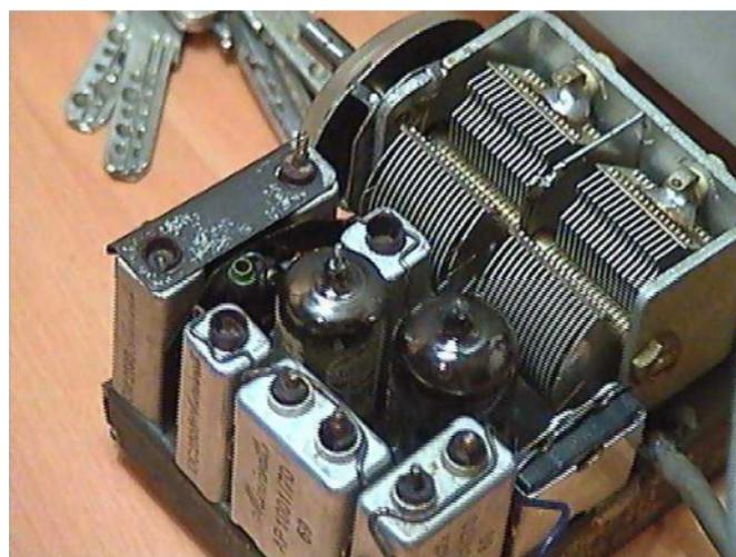
**Figura 6.** Condensador variable de un antiguo receptor de radio.
