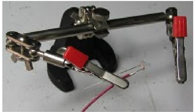
Ahora usando espagueti térmico (heatshrink) cubrir el cable expuesto. Se puede calentar el espagueti térmico con una pistola de calor o un secador de cabellos, pero se debe procurar no calentar el sensor ya que esto podría dañarlo. Si no se dispone de heatshrink, también puede usarse cinta eléctrica aislante.
